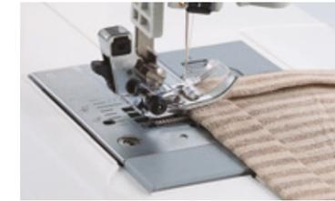
Обеспечивает необходимое положение прижимной лапки для обработки узлов с изменяемой толщиной, например в начале шва или при пересечении швов.
