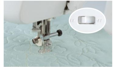
Рычаг опускания рейки используется при необходимости для свободной подачи ткани, при стегальных работах, вышивке и выстрачивании монограмм.
