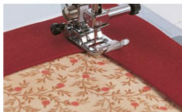
Не требуется поворачивать маховик машины, чтобы опустить иглу. При обработке углов выберите функцию «остановка иглы в нижнем положении» и поверните ткань необходимым образом, а при обработке прямых швов выберите функцию «остановка иглы в верхнем положении».
