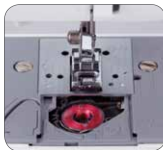
Быстрая установка шпульки
