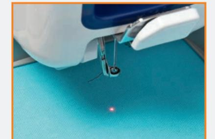
Der LED-Pointer hilft Ihnen bei der perfekten Positionierung der Nadel, da er genau den Punkt für den Nadeleinstich anzeigt.
