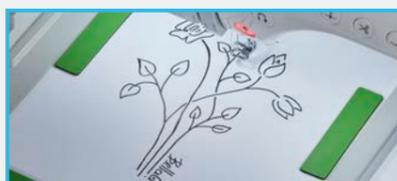
Mit der Scan-Funktion Motive einscannen und in Stickmuster umwandeln, direkt an der Maschine.
